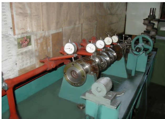
Рисунок 1 – Индикаторный стенд для измерения радиального биения фланца КВ, средних коренных шеек и шейки под распределительную шестерню относительно крайних коренных шеек
