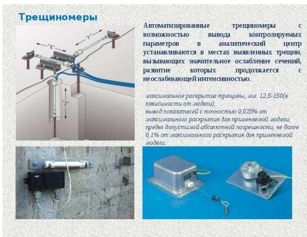
Рисунок 1. Автоматизированные трещиномеры
