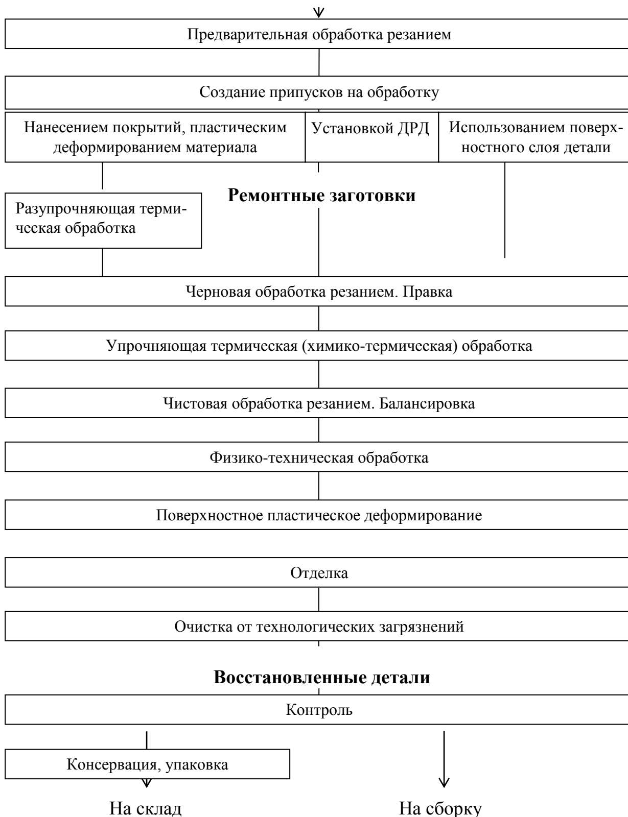
Рис. 2. Схема технологического маршрута восстановления деталей
